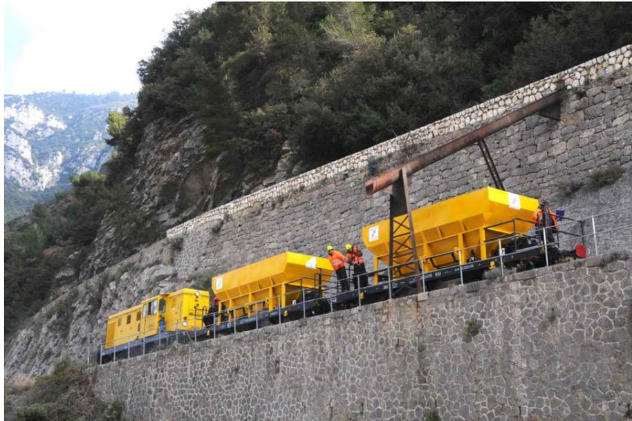
*Au départ de la base travaux de La Tinée, la BB Faur 60003 a alimenté en ballast les zones de travaux du Chaudan et d'Egleros, avec deux wagons trémies à bogies tout neufs, sortis des ateliers CFI à Criscior en... février 2019 !*
