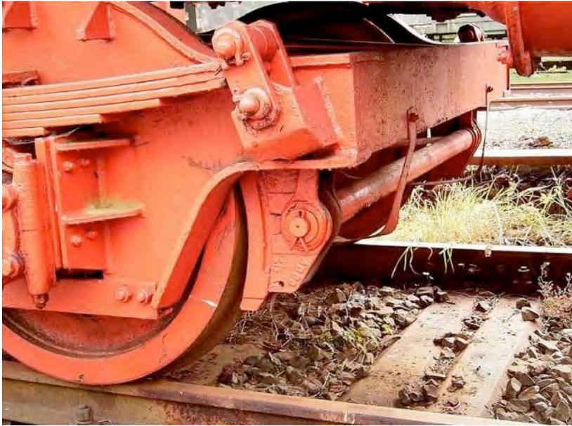
*Voici le principal coupable des bruits ferroviaires : les sabots de frein en fonte, vu ici sur un très vieux bogie marchandises. Ils font un bruit d'enfer au moment de leur utilisation, et dégradent lentement les tables de roulement des roues, accentuant alors considérablement les bruits de roulement.*
