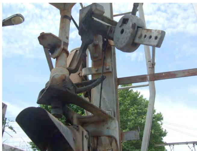
*Voici le coupable : le contrepoid qui ramène mécaniquement brusquement le signal en position fermée*
