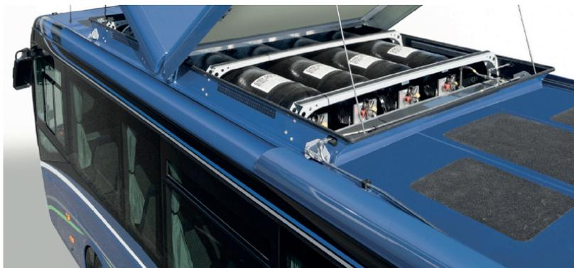
Il faudra aussi sans doute augmenter la capacité des réservoirs pour répondre à une autonomie supérieure à celle des autocars, mais la fragmentation des réservoirs GNV en plusieurs bouteilles rend leur insertion plus facile qu'un gros réservoir unique pour le Gasoil. Comme le montre la photo ci-contre, l'insertion des bouteilles dans la toiture est facile sur un autocar neuf.
