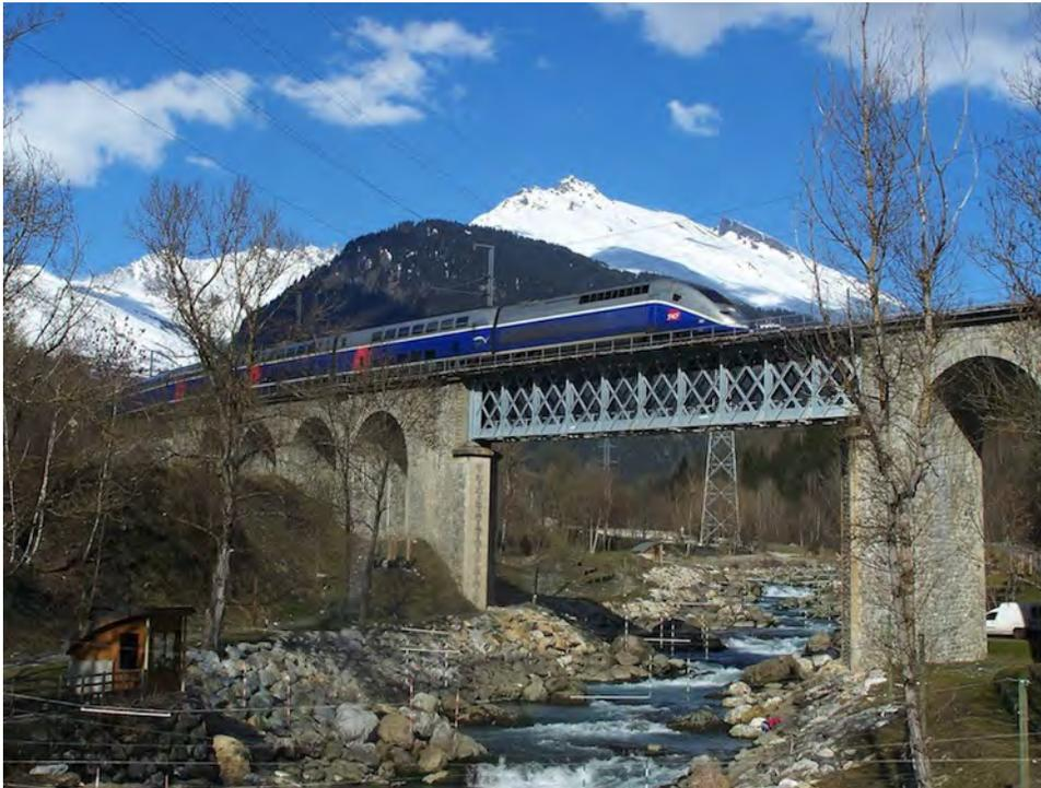
Il a donc bien fallu se résoudre à limiter la puissance des rames TGV à 2 niveaux en 1500 V continu.
