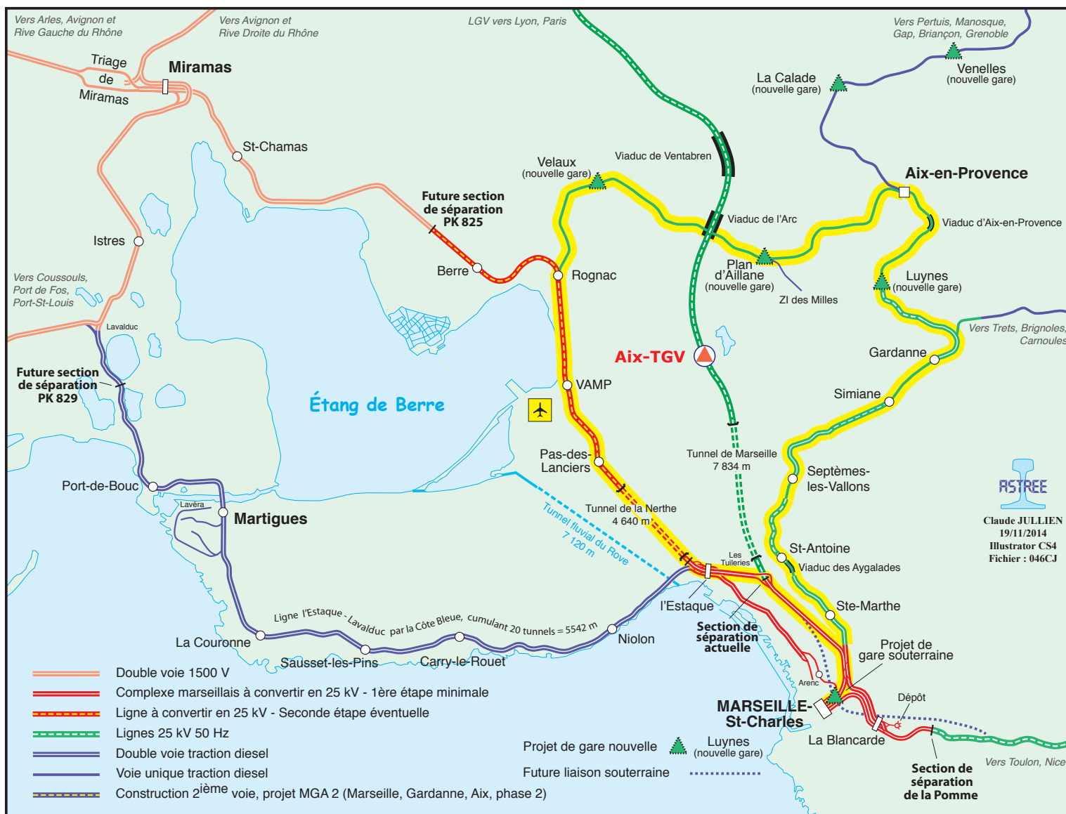
La carte ci-dessus se place dans l'hypothèse où à la suite de divers événements survenus dans la région marseillaise : électrification de Marseille - Aix, électrification complète du "Ring", construction de la gare souterraine St-Charles, la décision est prise de faire basculer l'ensemble du complexe ferroviaire marseillais en 25 kV.
